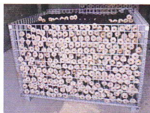
もみからの容積を約 1/10 にまで圧縮！ メッシュバレットで保管可能（約 700kg）
